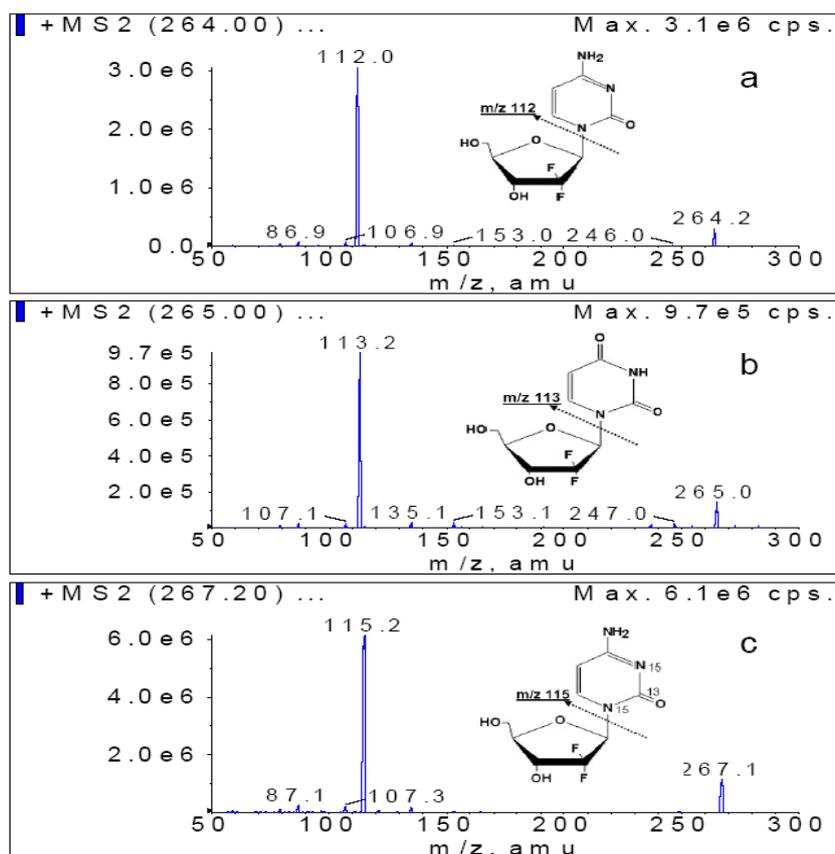
Fig.3. MS/MS product ion scan of a: gemcitabine (precursor ion m/z 264); b: dFdU (precursor ion m/z 265); c: Gemcitabine-13C, 15N2 (precursor ion m/z 267).
